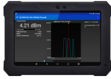
5000-NG RF Power Meter Display
